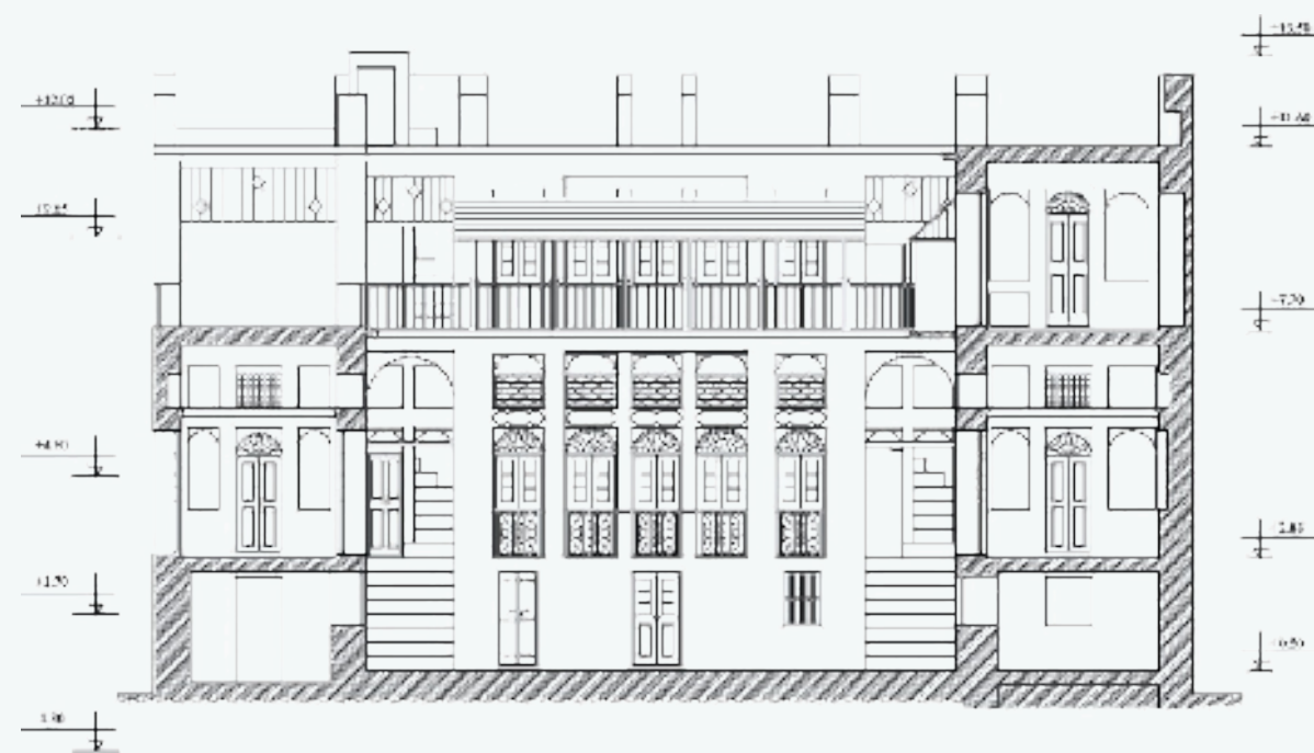
برش طولی عمارت گلشن- انتقال فضای اصلی زندگی به طبقات بالای همکف- ارتفاع بنا در طبقه همکف نسبت به اول کم تر می باشد و نسبت ارتفاع به عرض حیاط یک به یک است.
